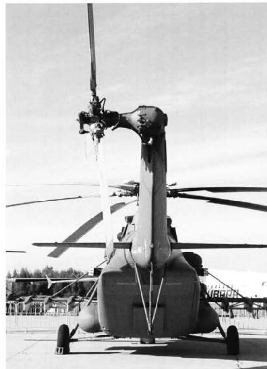
MAKS-2013 ollut Mi-8AMTSh (Mu-8AMTIII) -kopterin rungon takaosa eroaa perinteisestä Mi-8/-17:n vastaavasta uudelleenmuotoilulla takaosallaan, joka sisältää myös rampin. Rampin keskellä olevaa pienempää luukkaa ei Mi-8 MTV-5 -kopterissa ole.
