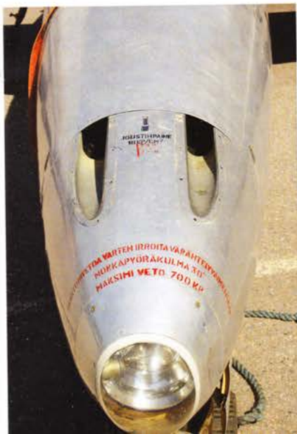
Alla. Fougan nokkakonekiväärien kourut avonaisina, ilman aseiden piippuja. Kuva IK
