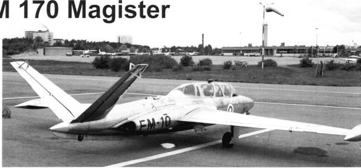
Ranskalaisvalmisteinen FM-10 Porissa vuonna 1982. Siivessä ranskalaismallinen kapeneva siiveke ja lyhyet trimmilaipat. Kuva IK
