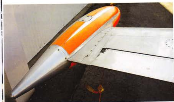
Suomalaista valmistusta oleva FM-42, jossa suomalais-tyyppinen siipi. Siiveke ja siivenpään saumoitus eroavat sarjan ranskalaistyyppisestä vastaavasta. Kuva IK
