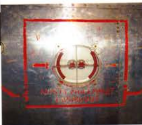
Lähikuva ohjaamoiden kuomujen pakkolaukaisuvivusta. Kuva IK
