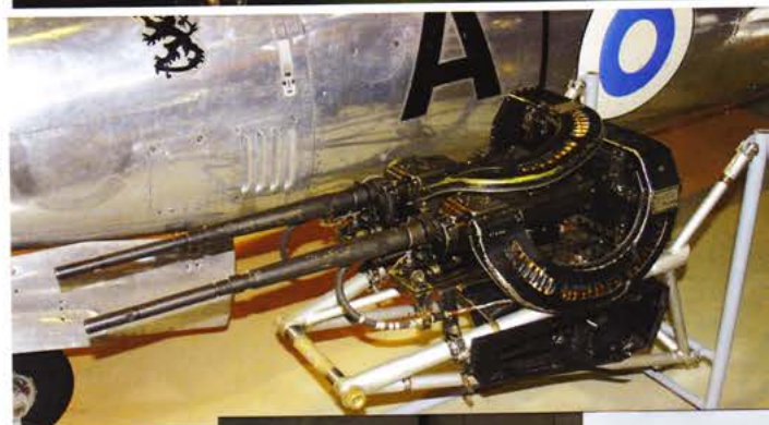
Oikealla. Suomessa käytetty Fouga koneiden 7.5 mm:n M.A.C 52 -kk.
