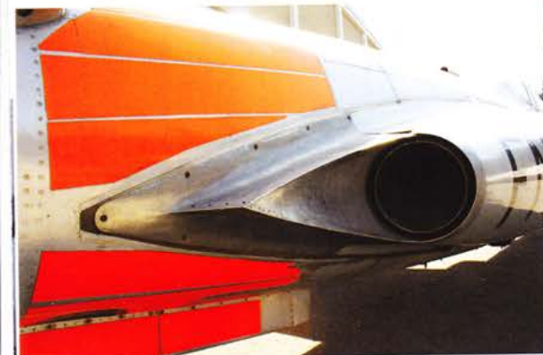
FM-42 koneen oikeanpuolisen moottorin poistoilma-aukko. Kuva IK
